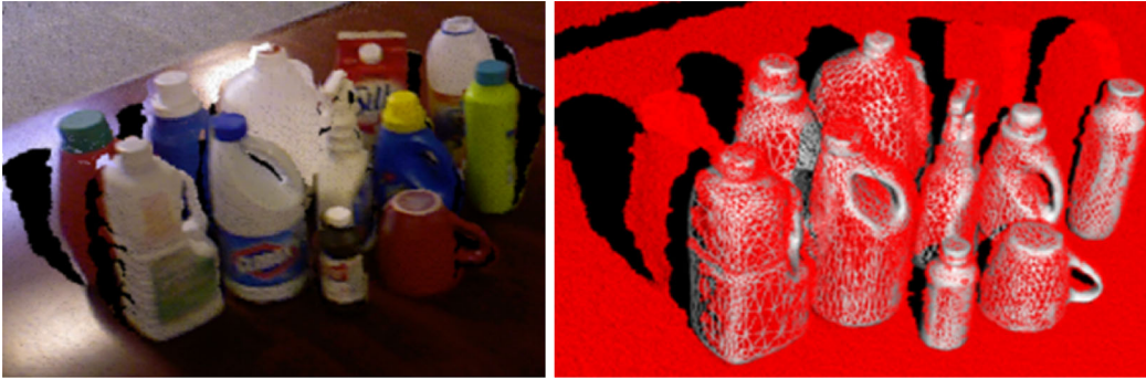
Abb. 3. Tischszene und die erkannten Objekte. Objektmodelle aus dem Web und durch manuelle Modellierung optimal eingepasst in die vom Roboter aufgenommen Punktwolke einer Tischszene
